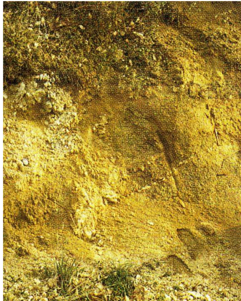
Figura 6.6. Gneiss completamente alterati o «saprolite» (classe V) (Cascini et al., 1992).
