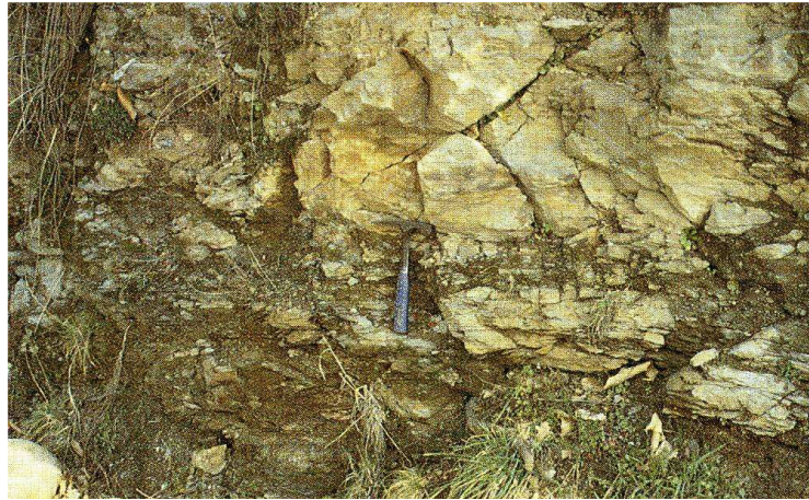
Figura 6.5. Gneiss altamente alterati (classe IV) (Cascini et al., 1992).
