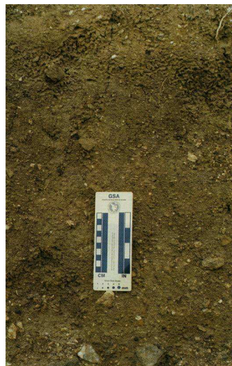
Figura 6.8. Colluvione (classe VI) (Cascini et al., 1992).
