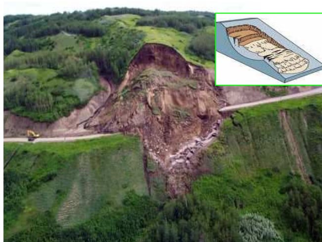
Figura 2.8. Esempio di scorrimento rotazionale.
