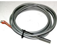
Termo-resistenze Pt100, Classe A: 0.15+0,002 |T| T amb, T sotto cella, T su cella
