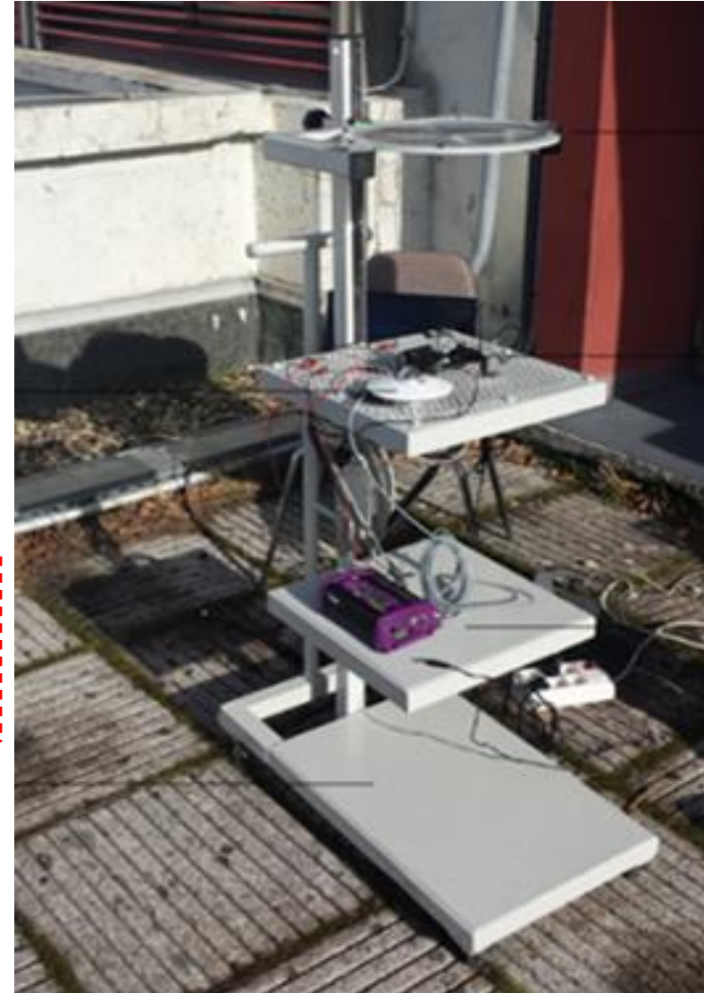
DataLogger 5 canali analogici (± 30V sensori)
