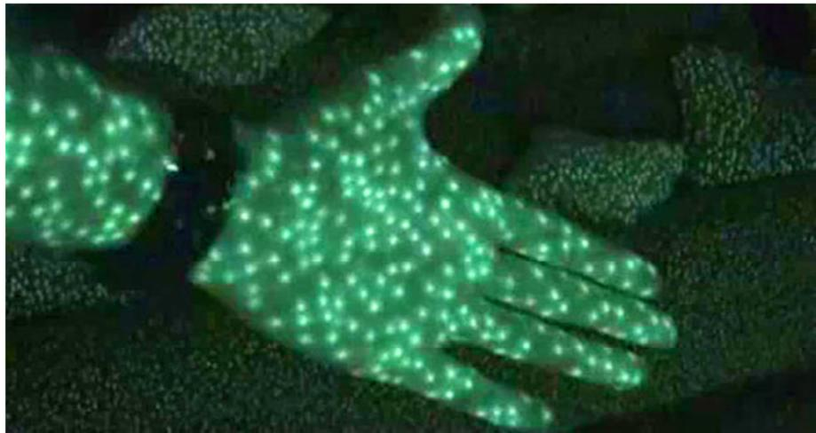
Figura 63 - Pattern infrarosso emesso dal *Kinect*
