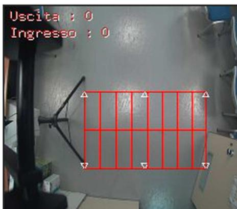
**Figura 78 – Flusso video visualizzato nell'interfaccia web con contatori di ingresso/uscita**
