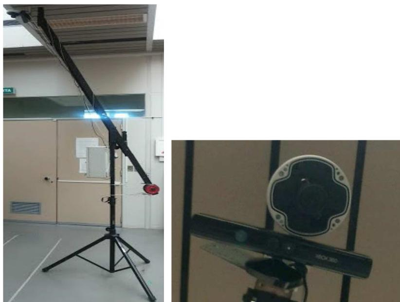
Figura 22 - Installazione dei sensori RGB e DEPTH
