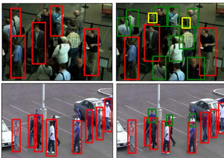
Figura 18 - Casi di occlusione con telecamera non in posizione zenitale
