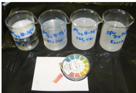
Figura III.2.1.[2]. Prove di precipitazione di sPSB-SA, da destra verso sinistra: in acqua, metanolo, acetonitrile ed esano.
