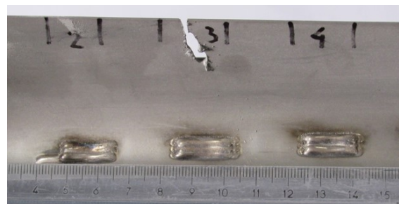
Figure.3: pala statorica riparata mediante deposizione diretta di polvere
