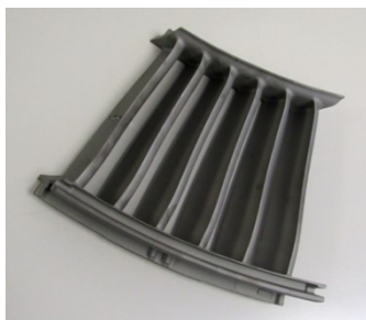
Figure.3: pala statorica riparata mediante deposizione diretta di polvere
