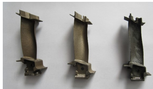
Figure.2: produzione additiva di pale di turbina in Inconel 718
