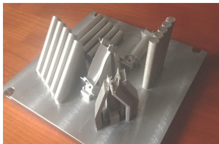
Figure.2: produzione additiva di pale di turbina in Inconel 718
