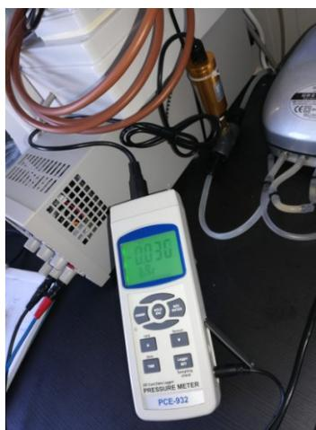
Figura 5.51 Trasduttore di pressione con manometro da 2 bar
