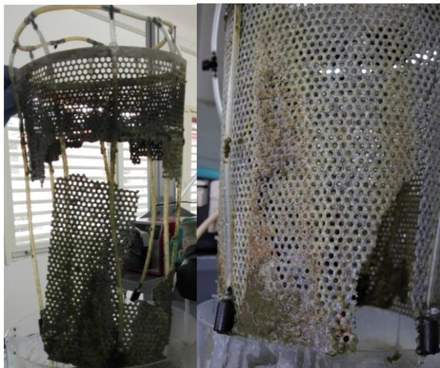
**Figura 6.28** Alluminio dopo il run sperimentale e-AAS-MBR (a sinistra) e il run e-AAS-ESFDMBR (a destra)
