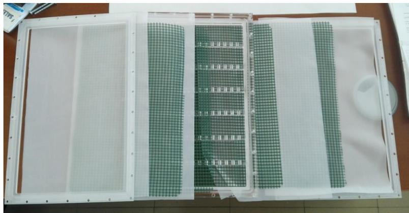
Figura 5.7 Assemblaggio struttura per formazione membrana dinamica a scala pilota
