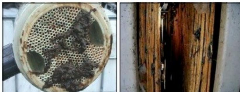
Figura 2.12 Fouling delle membrane (Ricco et al., 2013)
