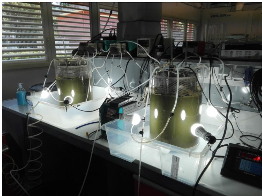
**Figura 5.26** Impianto AAsMBR ed e-AAsMBR a scala di laboratorio
