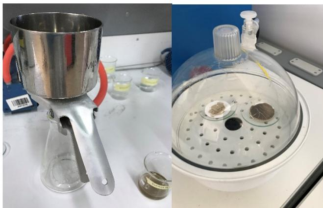
Figura 5.46 Filtrazione a vuoto della miscela aerata, filtri dopo stufa
