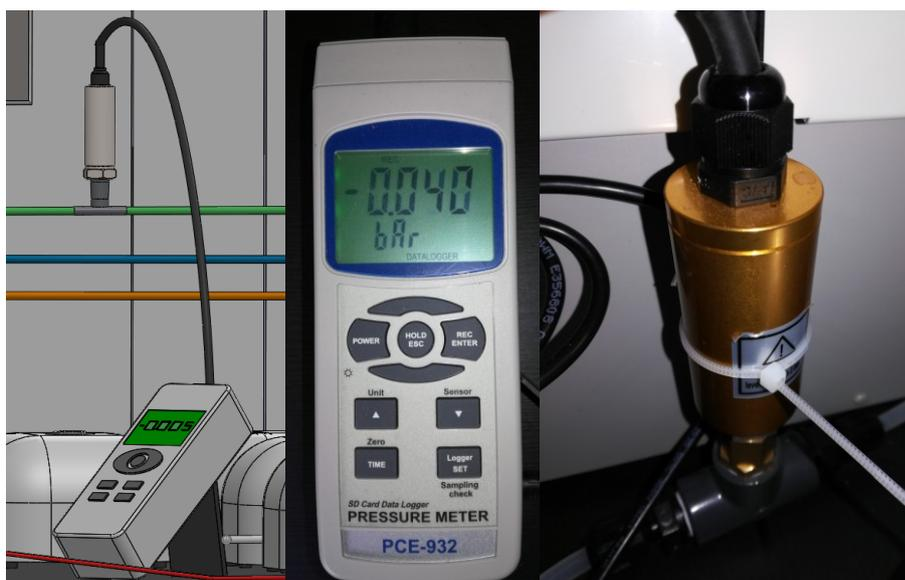
Figura 5.35 Manometro portatile e trasduttore di pressione di 2 bar progettazione (a sinistra) e vista reale (a destra)
