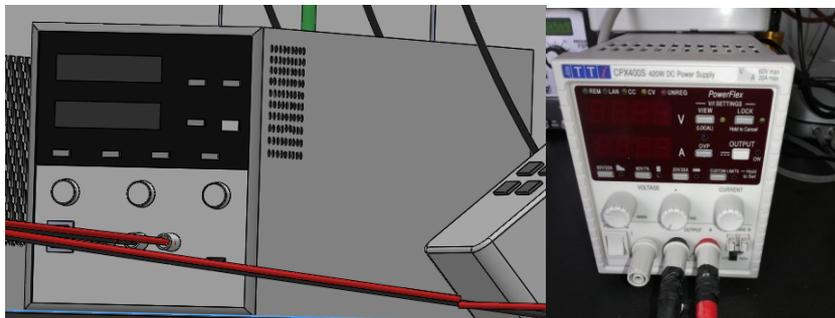
Figura 5.34 Generatore di corrente continua (CC), progettazione (a sinistra) e vista reale (a destra)
