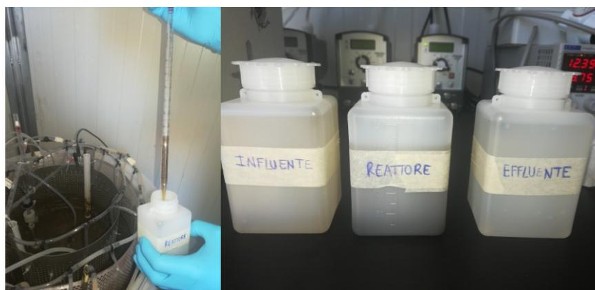
Figura 5.44 Prelievo del campione dal reattore biologico (a sinistra) e campioni per le analisi di laboratorio (a destra).
