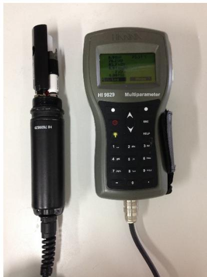
**Figura 5.47 Sonda ad immersione (Hanna HI9829 Multiparameter).**
