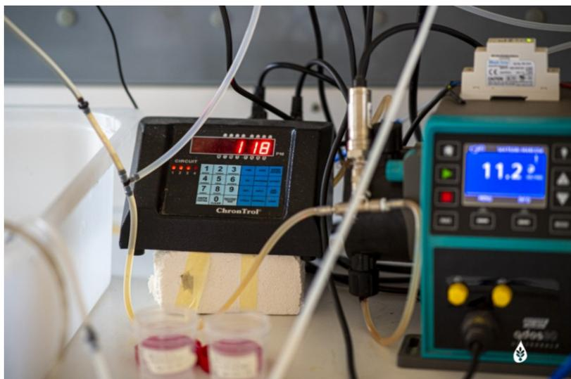
Figura 5.15 Particolare del timer, misuratore di pressione e pompa dosatrice permeato
