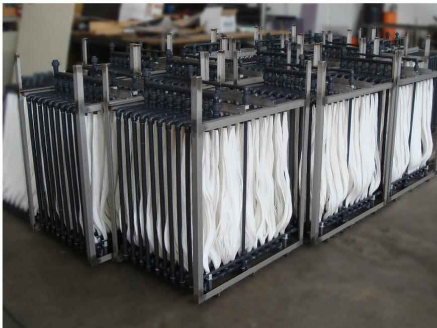
**Figura 2.3** Modulo a membrana a fibra cava (sepra.it).
