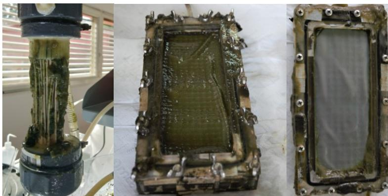
**Figura 6.30** Membrana tradizionale nel sistema AAS-MBR prima del lavaggio chimico (a sinistra), AAS-ESFDMBR a fine ciclo (al centro) e e-AAS-ESFDMBR a fine ciclo (a destra)
