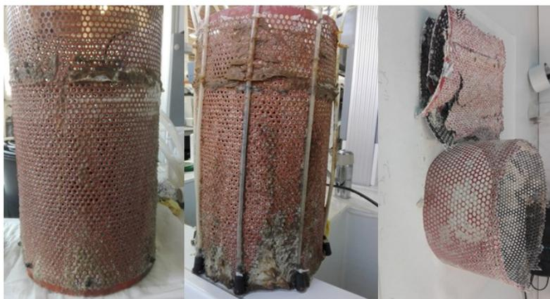
Figura 6.18 Da sinistra verso destra: elettrodi in alluminio alla fine del run sperimentale con densità di corrente di 0.3, 0.5 e 0.9 mA/cm<sup>2</sup>
