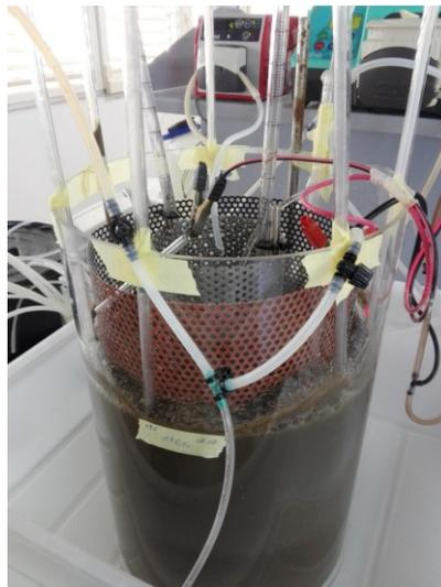
Figura 5.21 Particolare dell'elettrobioreattore a membrana dinamica autoformante incapsulata
