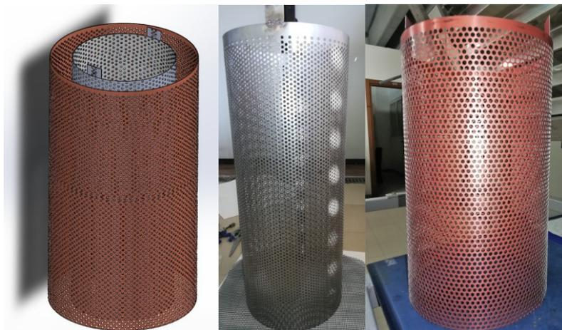
Figura 5.37 Anodo e catodo progettazione (a sinistra) e vista reale (a destra).
