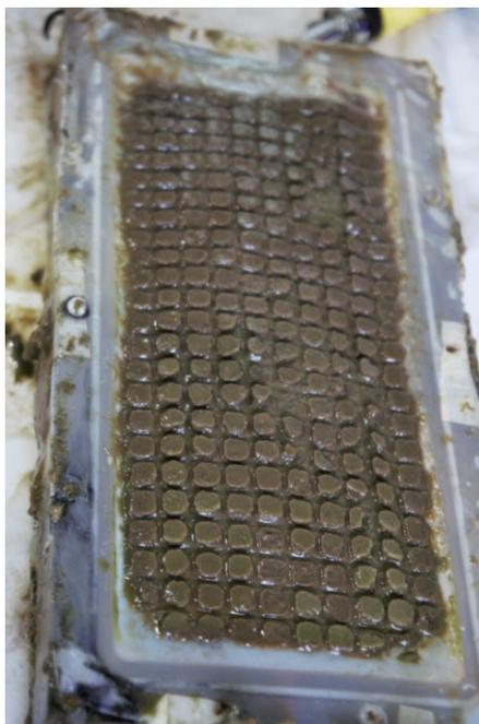
Figura 6.32 Membrana dinamica autoformante incapsulata formatasi nel reattore e-AAS-ESFDMBR
