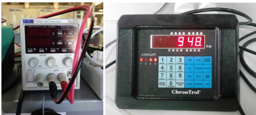
Figura 5.19 Generatore di corrente (a sinistra) e timer control (a destra)
