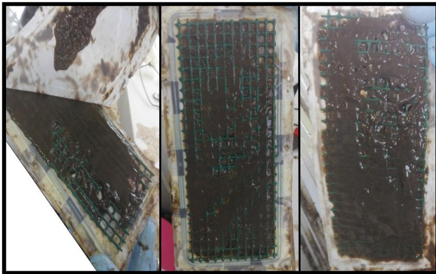
**Figura 6.12** Membrana dinamica incapsulata tra due strati di dacron alla fine del run sperimentale
