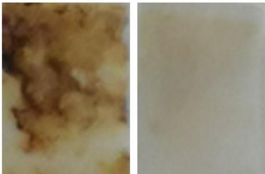
Figura137. Provino di marmo di Carrara prima (a sinistra) e dopo (a destra) il trattamento con deferiprone
