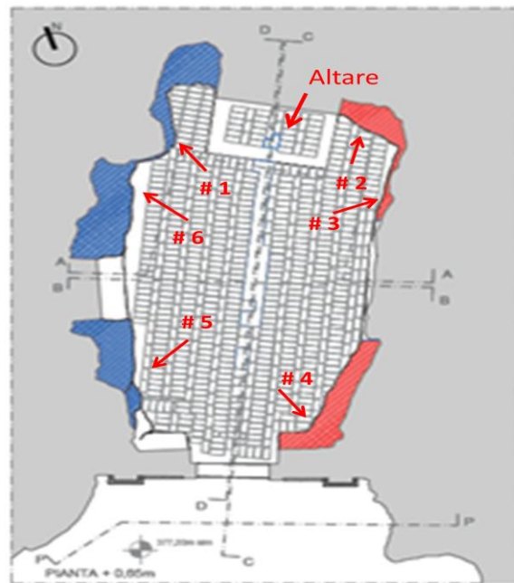
Figura 76. Pianta Madonna dei Derelitti: ubicazione dei campioni per analisi XPS e trattamenti (Tab Consulting, 2019; Casieri et al., 2021)
