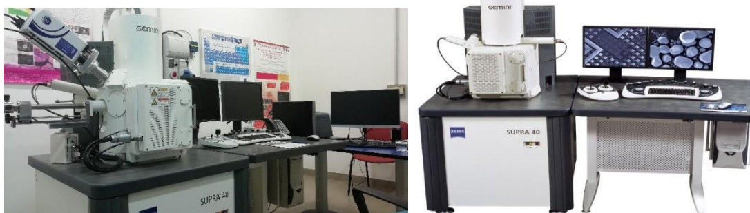
Figura 8. Il microscopio con sorgente ad emissione di campo Zeiss Supra 40 (CNR-IMAA)
